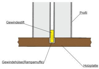
Verbindung von zwei Profilen durch die Glas- oder Holzplatte hindurch mit Hilfe eines Gewindestiftes
